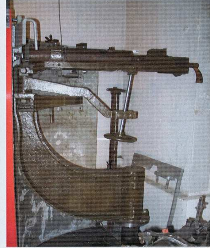
Podstawa ckm wz.30 na ramieniu obrotowym Z kopuły panczernej OWS. Produkcji Wspólnoty Interesów KATOWICE 1938r- Muzeum Śląskie w Katowicach.
