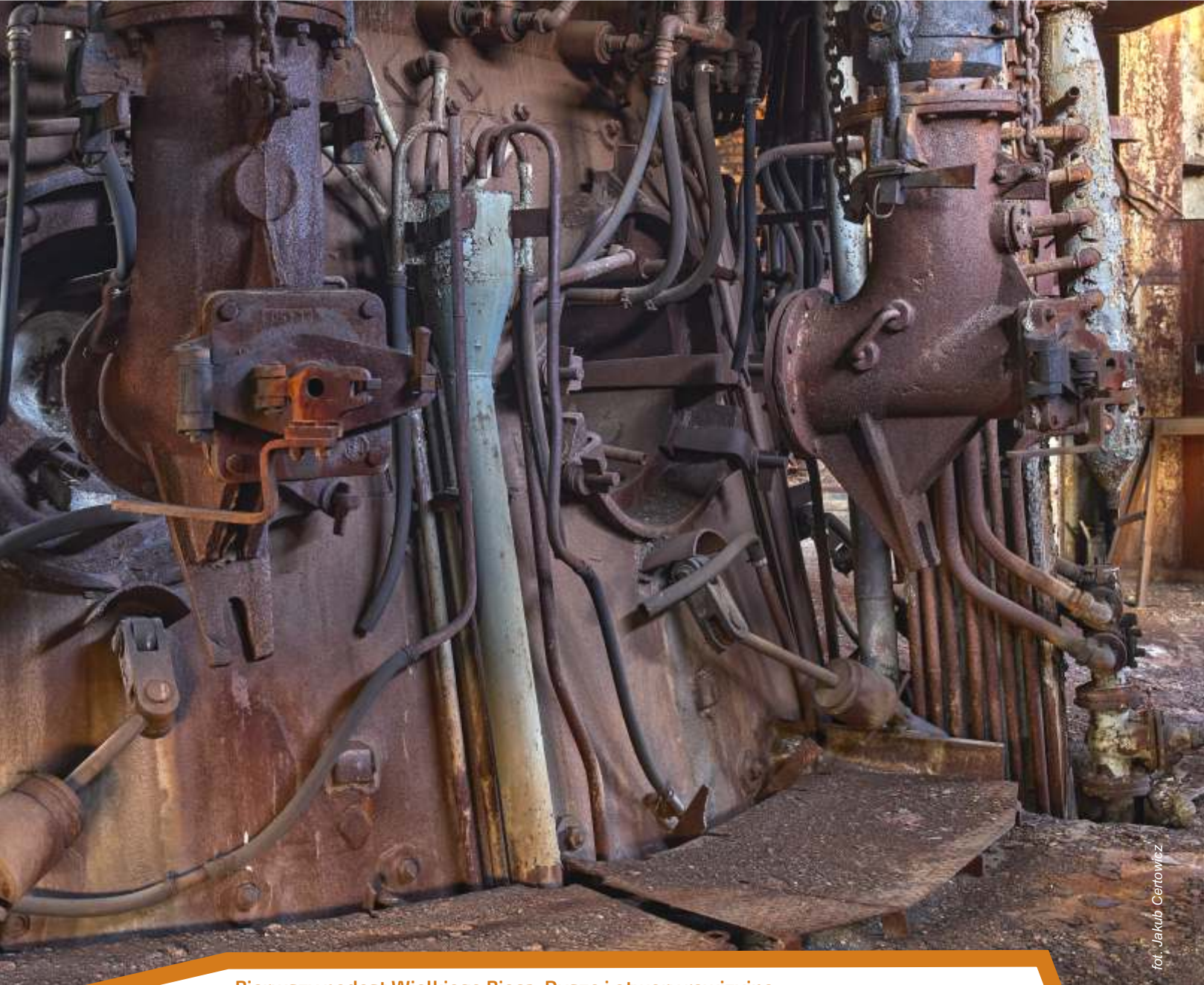
Pierwszy podest Wielkiego Pieca. Dysze i otwory rewizyjne. The first platform of the Blast Furnace. Nozzles and inspection holes.
